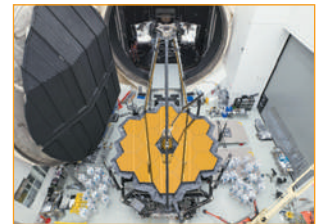
Рис. 3.2 Сегментоване дзеркало новітнього телескопа «Джеймс Уебб»
