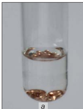
Мал. 53. Відношення міді до розбавленої (а) і концентрованої сульфатної кислоти (б)
