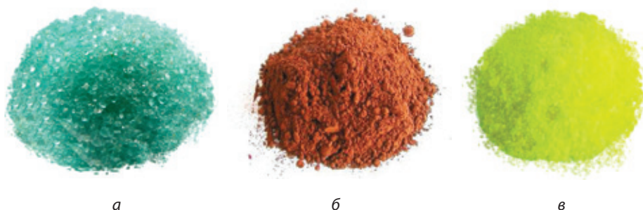
Мал. 35.1. Солі: a — ферум(II) сульфат (залізний купорос) \text{FeSO}_4 ; б — ферум(III) хлорид \text{FeCl}_3 ; в — калій хромат \text{K}_2\text{CrO}_4
