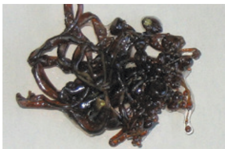
Мал. 21.2. а — кристалічна сірка; б — аморфна пластична сірка
