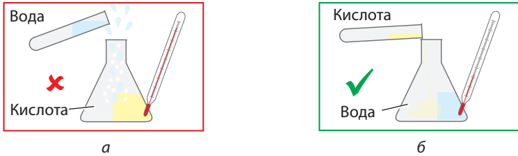
Мал. 33.2. Розбавлення кислоти водою: а — неправильно, б — правильно
