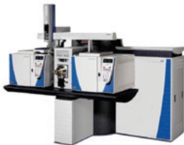
Мал. 41.3. Мас-спектрометр — прилад для визначення відносних атомних і молекулярних мас
