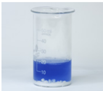
Мал. 31.3. Універсальний індикатор за наявності кальцій гідроксиду набуває синього кольору
