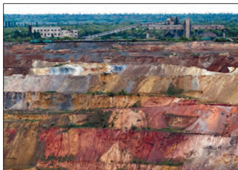
Мал. 3. Залізорудний кар'єр Південного гірничозбагачувального комбінату (місто Кривий Ріг): довжина — 3 км, глибина — до 400 м.
