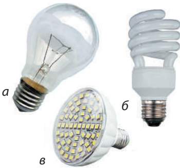
Рис. 24.3. Електричні лампи — пристрої, в яких електрична енергія частково перетворюється на енергію світла: а — лампа розжарення (ККД — 5 %); б — люмінесцентна лампа (ККД — 10–20 %); в — світлодіодна лампа (ККД — 50 %)
