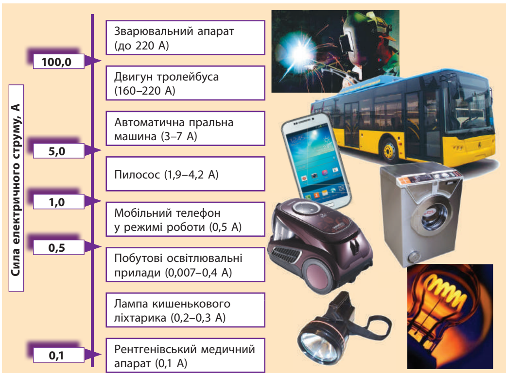
Рис. 27.4. Значення сили струму в деяких електротехнічних пристроях
