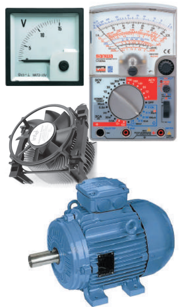
Рис. 24.6. Робота більшості електровимірювальних приладів і електричних двигунів ґрунтується на магнітній дії струму
