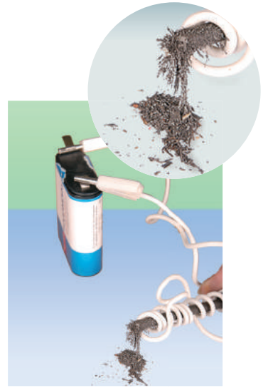
Рис. 24.5. Під час пропускання струму цвях стає магнітом і притягує до себе залізни ошурки
