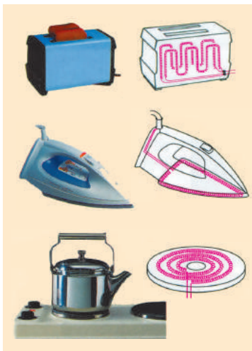
Рис. 35.2. Основна частина будь-якого електричного нагрівального пристрою — нагрівальний елемент
