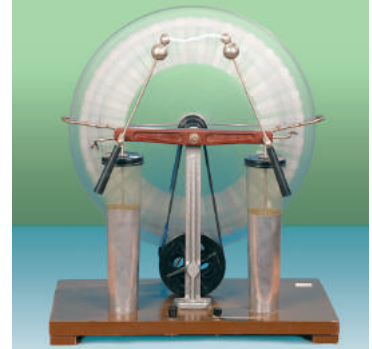
Рис. 40.1. Іскровий розряд між зарядженими кондукторами електрофорної машини
