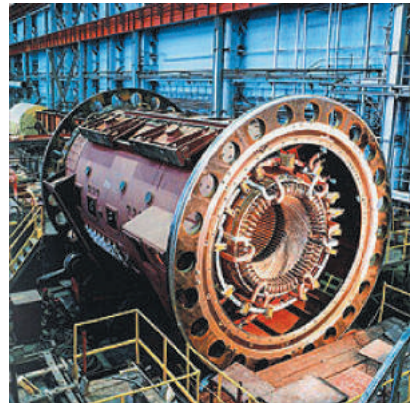
Рис. 25.2. Завдяки турбогенераторам, що перетворюють механічну енергію обертання турбін на енергію електричного струму, виробляють 80% споживаної у світі електроенергії
