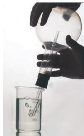
Рис. 2.1. Нагрівуючись, повітря в колбі розширюється, і деяка його частина виходить із колби — біля отвору трубки утворюються бульбашки повітря
